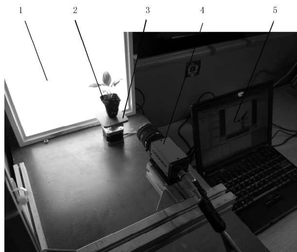
1.背光源 2.苗座 3.旋转载物台 4.视觉相机 5.PC 机
